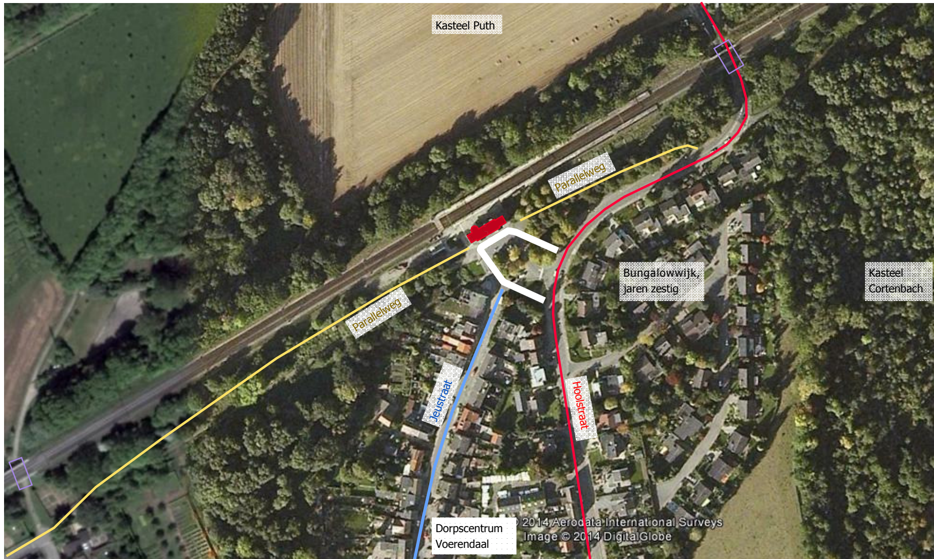
Afb. 3.1 Het station (rood) in de stedenbouwkundige structuur. Het stationsplein met de toeritten (wit) is in 1913 aangelegd op het knooppunt Hoolstraat-Jeustraart. Na aanleg van het stationsterrein werd aan weerszijden van het emplacement onder de iets verhoogde spoorbaan een tunneltje (paars) aangelegd voor de doorgaande wegen. De Hoolstraat (rood) werd met een bocht omgelegd naar het oosten. Het stationsplein werd een centraal punt waar de Parallelweg (geel), de Jeustraart (blauw) en de Hoolstraat samenkwamen.
